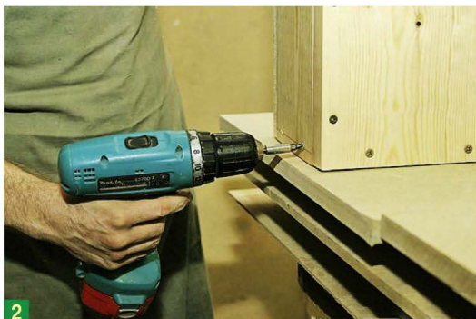
2 Аналогично прикрутите заднюю стенку к левой боковой стенке скворечника.
