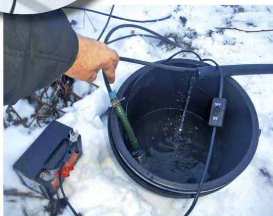
Установка для удаления ледяной пробки в садовом шланге в сборе. Достаточно включить насос, и процесс пошёл.
