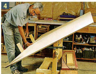
Поворот опорной рамы приводит листы в горизонтальное положение и автоматически фиксирует их на уровне стола циркулярной пилы.
