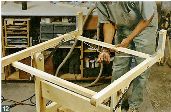
12 Чтобы вернуть опорную раму в вертикальное положение, надо потянуть шнур, проходящий вокруг рамы от конца одной защёлки через коуши к концу другой защёлки.
