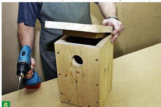
6 Вставьте крышку в корпус скворечника и закрепите её с боковых сторон.
