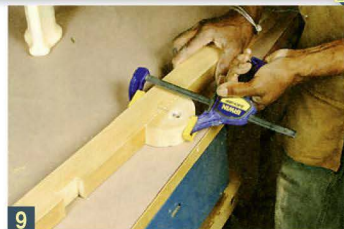
9 Поворотный блок по разметке надёжно крепится к боковине рамы.
