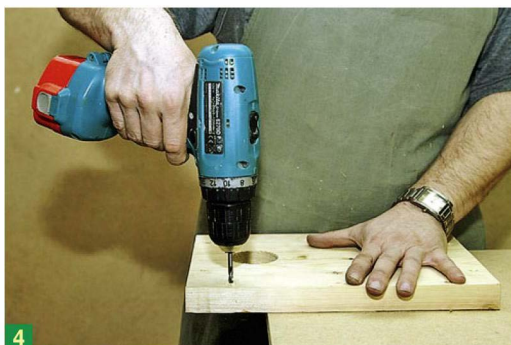
4 В передней и задней стенках скворечника просверлите отверстия \varnothing 4 мм под саморезы по всему периметру стенки на расстоянии 1 см от края. Достаточно по 2–3 отверстия на сторону.
