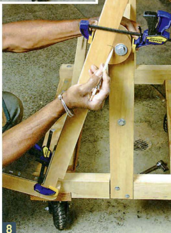
8 Определение положения опорной рамы на основании тележки и разметка узла её соединения со стойками рамы основания.
