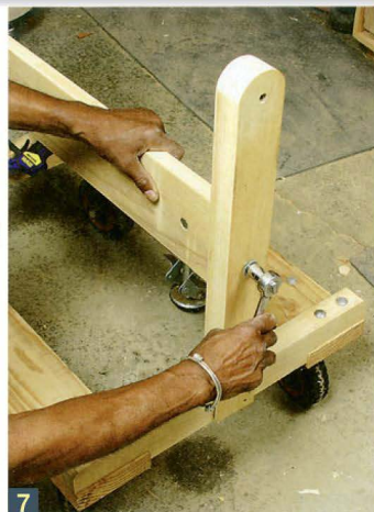
Сборка основания. Соедините четыре детали основания, прикрепите самоориентирующиеся ролики, прикрутите распорку и две стойки.
