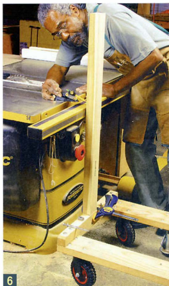
Высота установки поворотной опорной рамы определяется примеркой к столу станка.
