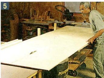
Тележка позволяет подать лист к пиле непосредственно с опорной рамы.
