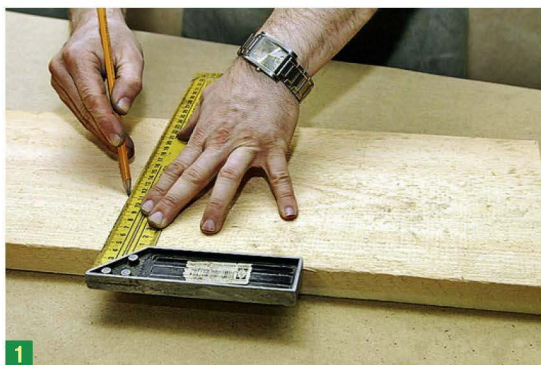
1 С помощью угольника и карандаша разметьте каждую деталь скворечника.
