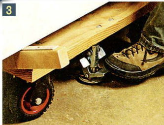
На месте тележка фиксируется упирающимся в пол столом.
