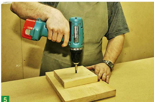
5 Соедините нижнюю часть крышки скворечника с верхней частью. Центр нижней части должен быть смещён от центра верхней части на 50 мм, чтобы перед летком домика получился козырёк.
