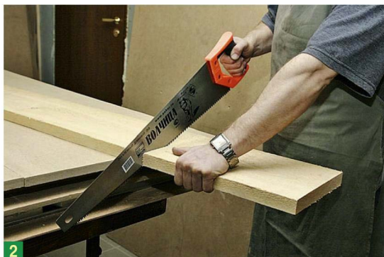
2 Затем отпилите деталь, используя ножовку или электролобзик. Разметку и отпиливание деталей нужно делать последовательно, чтобы парные детали получились одинакового размера.
